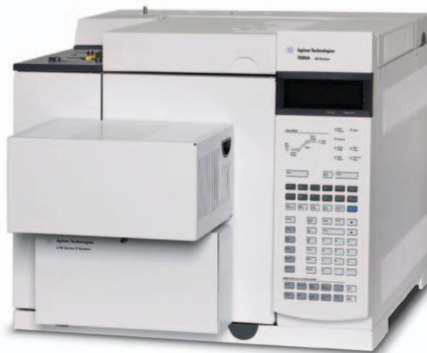
与传统空气浴气相色谱柱温箱技术相比，采用 LTM 系列 II 技术的安捷伦 7890A 气相色谱仪可非常有效地加热和冷却色谱柱，分析周期大大缩短。
