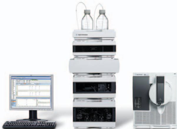
快速获得结果，且具有最高的可信度。6100 LC/MS 平台使您能够快速筛选化合物、确定分子量、纯化和定量分析复杂混合物中的目标化合物并鉴定杂质。
