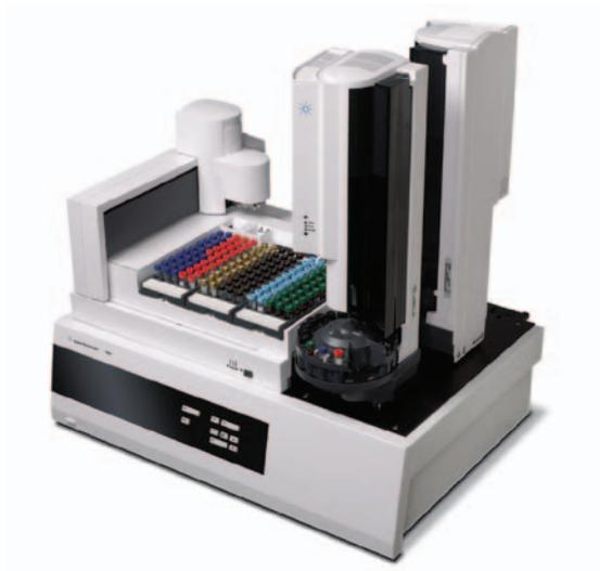
Agilent 7696A 样品制备工作台适用于大多数常见的 HPLC、GC、LC/MS 和 GC/MS 应用。
