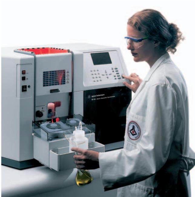
带有 SIPS 配件的安捷伦 55B 原子吸收光谱仪
